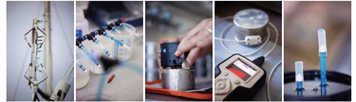
Das 3-D-Anemometer misst die Windgeschwindigkeit. Die hydraulischen Eigenschaften und die Wärmeleitfähigkeit eines Bodens werden dagegen im Labor gemessen.
