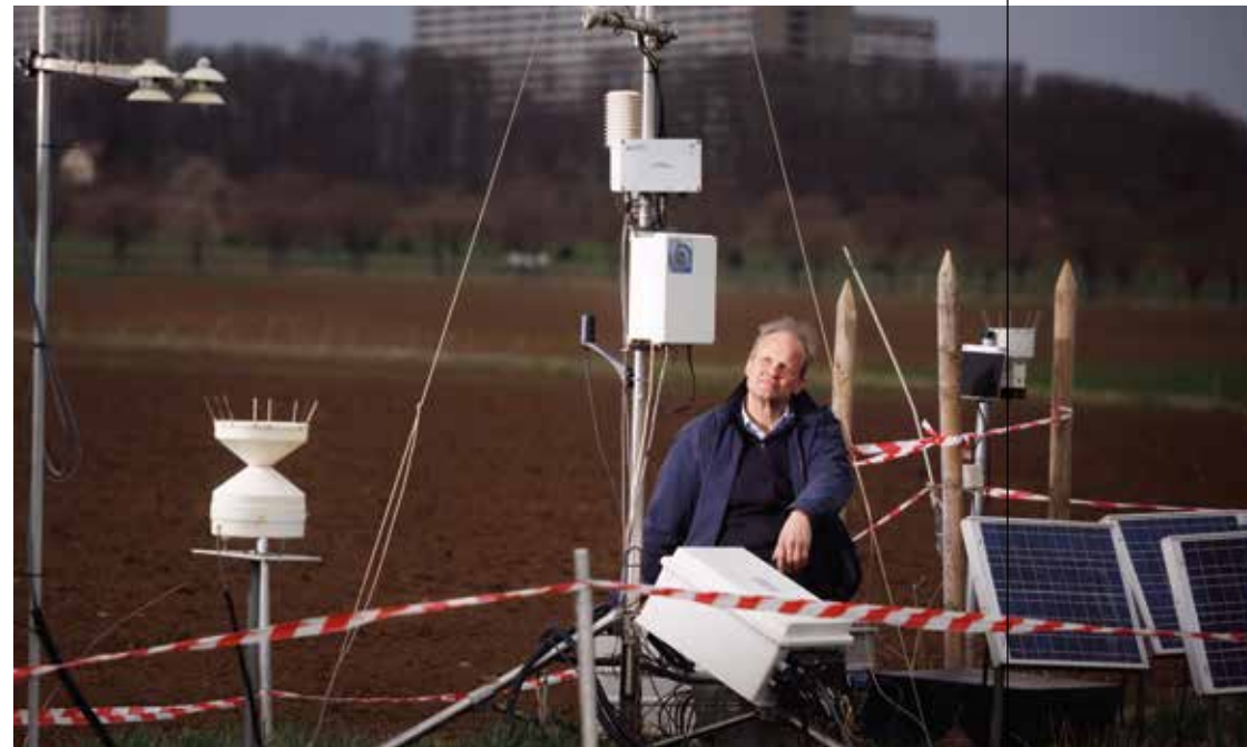
Man sieht es nicht, aber zwischen der Landoberfläche und der Atmosphäre sind Wärme, Wasserdampf und CO 2 unterwegs. An der Eddy-Kovarianz-Station können deren Flüsse gemessen werden.
