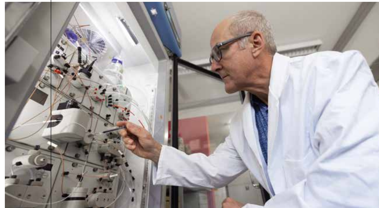
Die Proteine müssen gereinigt werden. Dafür injiziert Andreas Schaller einen Pflanzenextrakt in die Chromatographieanlage.
