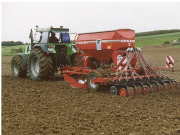
Getreidemulchsaat mit zeitgemäßer Technik direkt im Anschluss an die Kartoffelernte Anfang Oktober in Schwaigern-Massenbach
